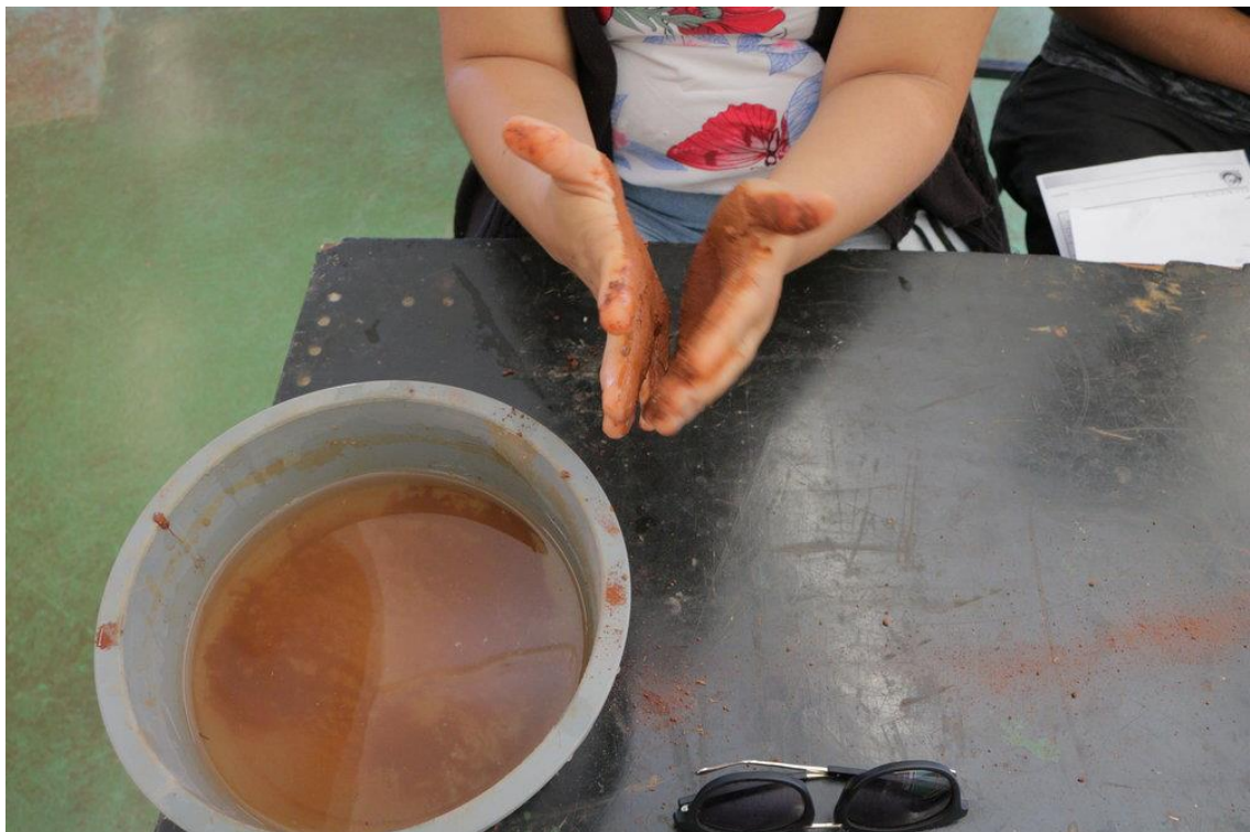
Figura 39 – Realização do exame de água corrente
