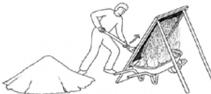
Figura 14 – Processo de peneiramento do solo
