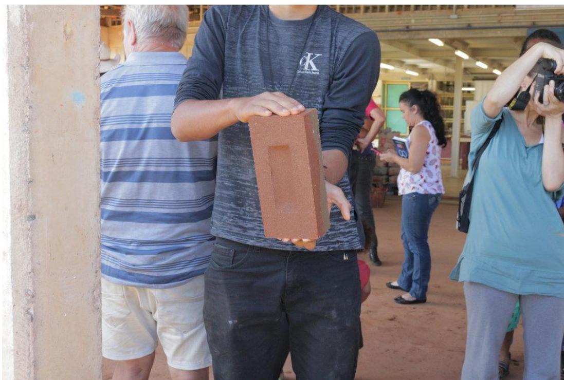
Figura 55 – Resultado do processo (BTC com duas colorações)
