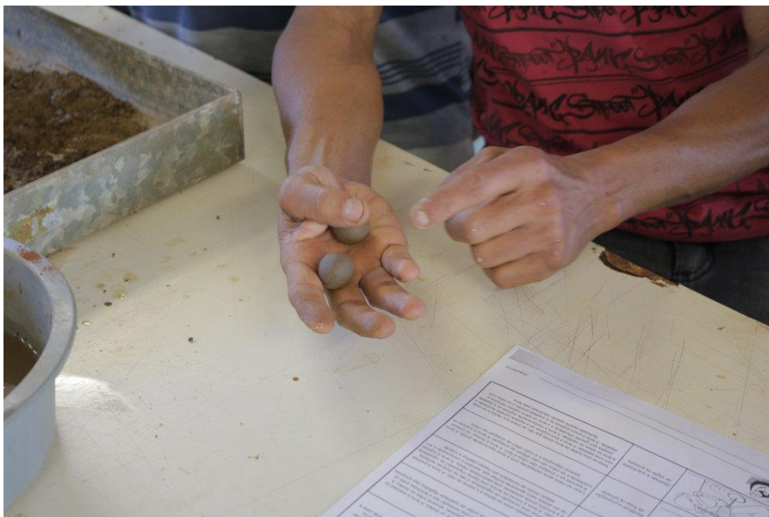
Figura 40 – Realização do exame de aderência (confecção de “bolota”)
