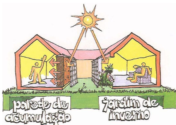
Figura 19 – Exemplos de ganho solar indireto
