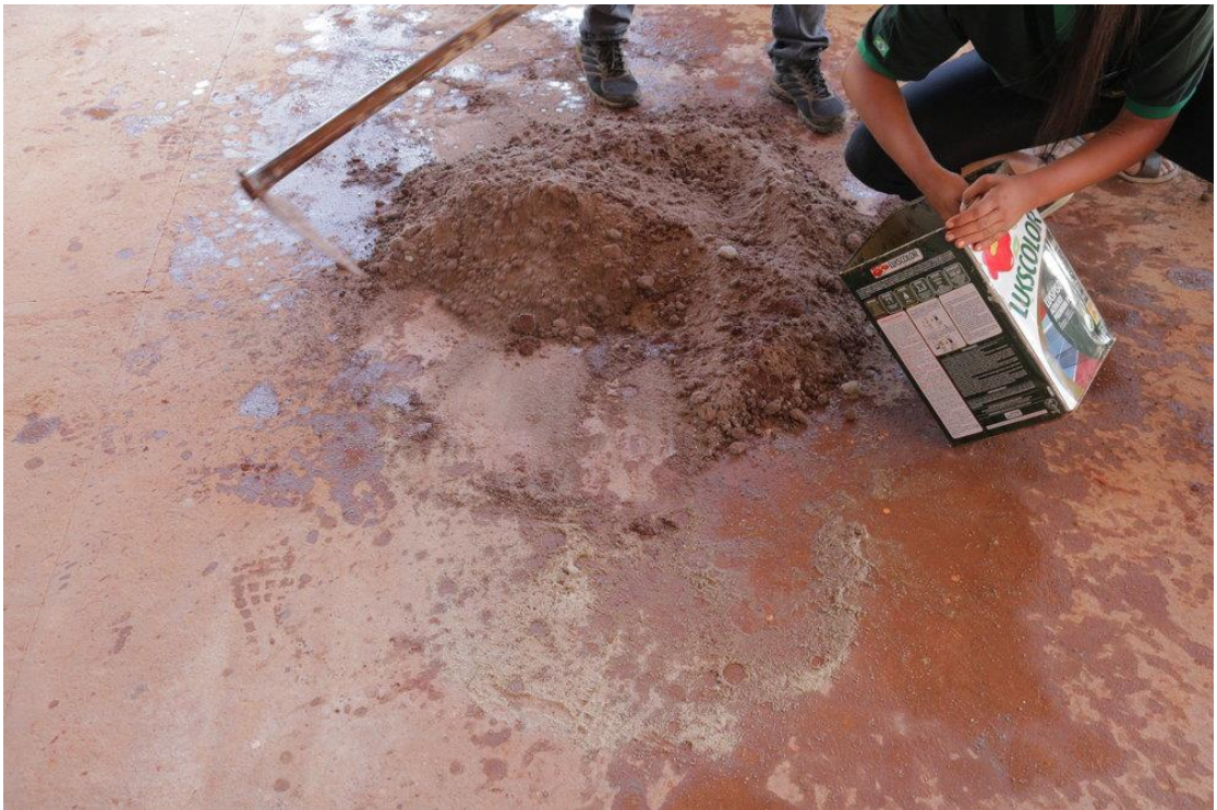
Figura 44 – Processo de umidificação do solo
