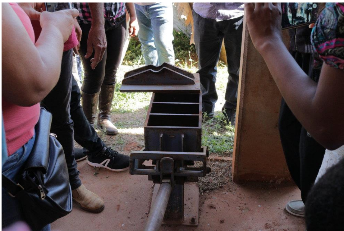
Figura 48 – Prensa mecânica para produção de tijolo maciço
