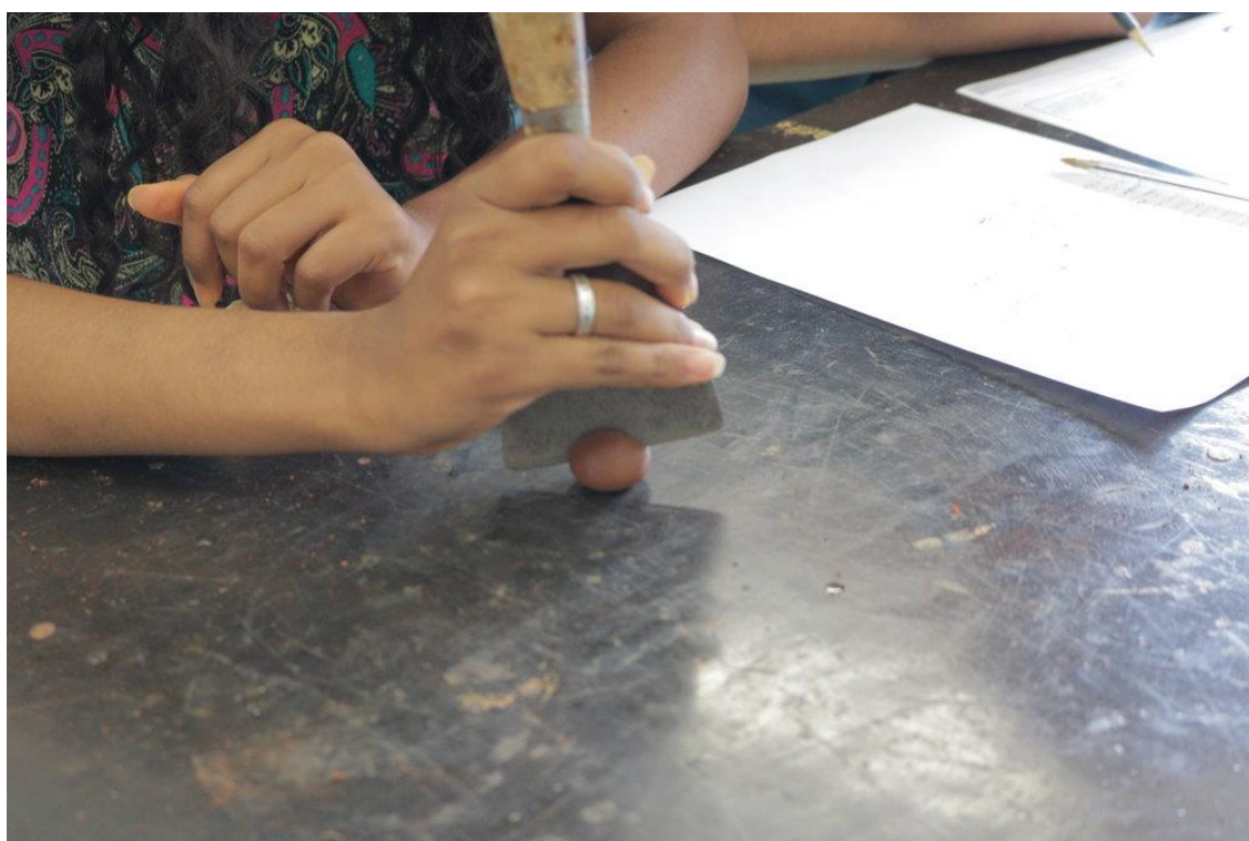
Figura 41 – Realização do exame de aderência (divisão com a espátula)
