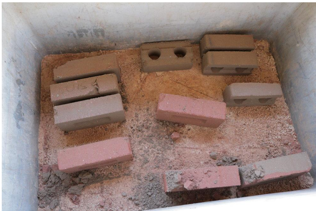
Figura 54 – Material colocado em reservatório para passar por processo de cura
