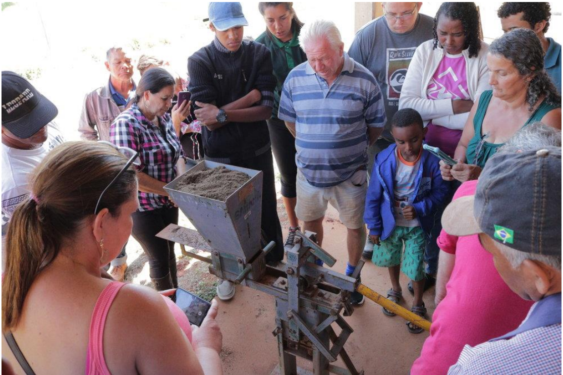
Figura 46 – Prensa mecânica para produção de tijolo vazado
