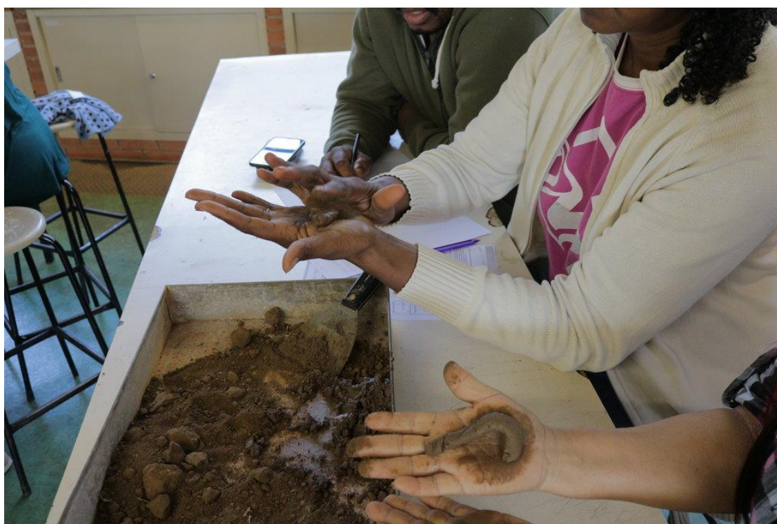
Figura 37 – Realização do exame tátil (verificação de plasticidade)
