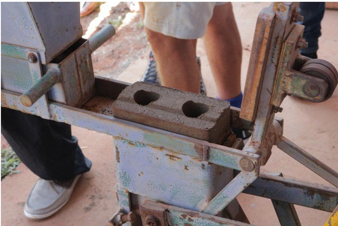
Figura 47 – Tijolo vazado saindo da prensa
